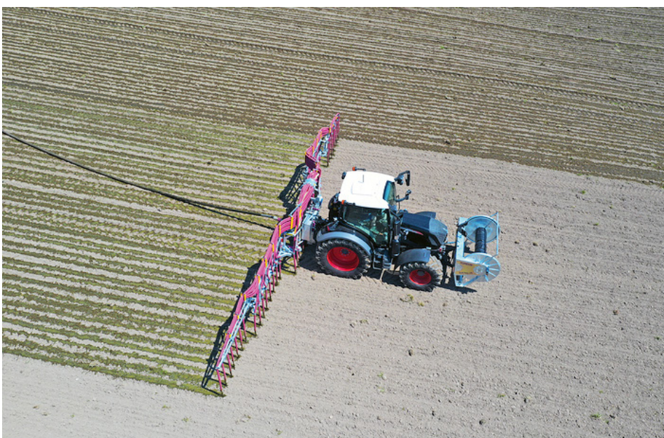
Das Ausbringen von Gülle mit Schleppschläuchen reduziert Stickstoffverluste. In Bezug auf die Belastung des Wassers genügt das aber noch nicht.
